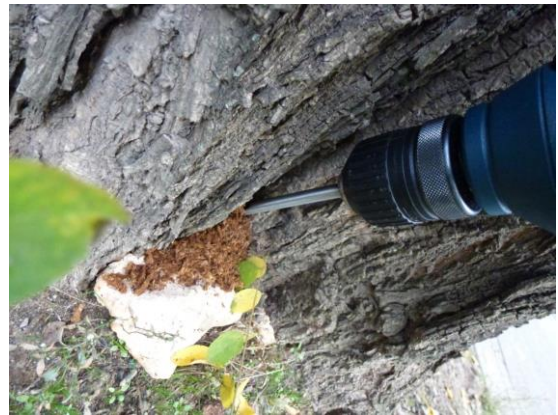
Ausgeworfene Bohrspäne zeigen Holzfäule
