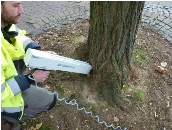
Resistographen-Messung am Stammfuß
